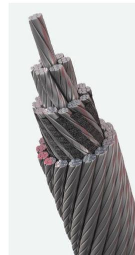
Le **câble de levage Notor HP 49** est un câble antigiratoire pour les **applications de grande hauteur**, y compris grues à tour, grues mobiles, grues d'exploitation offshore ou tout autre appareil de levage à hauteur élevée nécessitant une importante résistance à la rotation.
