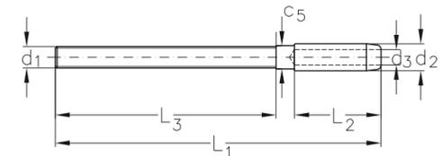
La **mini terminaison à filetage long** de référence DBGM LONG de la marque Waltermann est un accessoire pour câbles en inox. Ce produit est pour un **filetage à droite ou à gauche**. Nous vous proposons un accessoire pour un **diamètre allant de 3 à 10 mm**.
