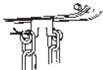
Raccorder les chaînettes de suspension aux emplacement prévus
